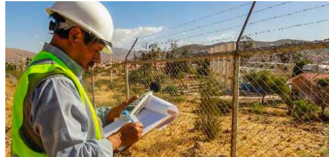
▲ Medición de niveles sonoros de ruido perimetral efectuado por el Laboratorio Ambiental Punto Alto – Central Termoeléctrica Valle Hermoso
