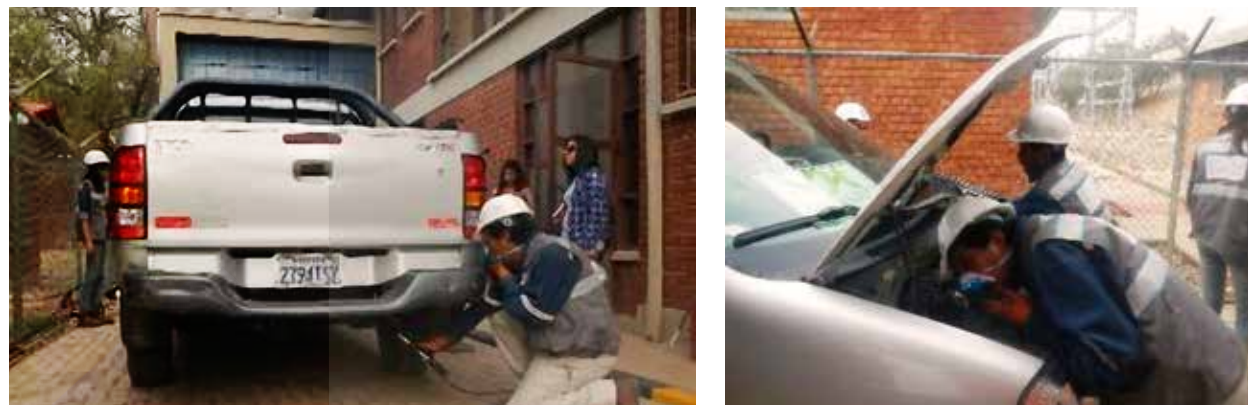
▲ Monitoreo y medición de gases en fuentes móviles parque automotor ENDE VALLE HERMOSO S.A. y Servicio de Transporte – Central Termoeléctrica Valle Hermoso
