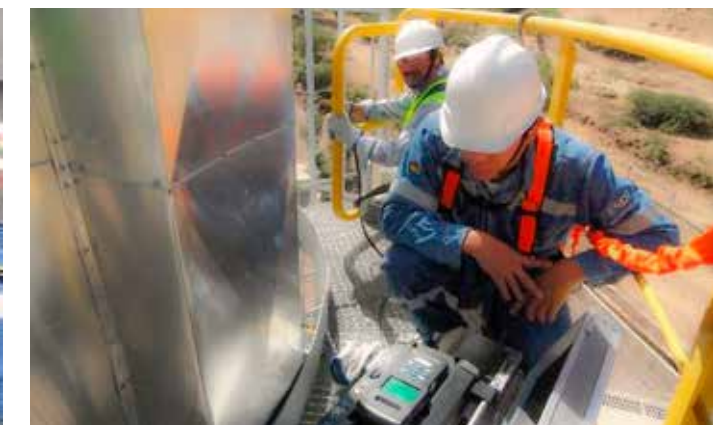
▲ Monitoreo y medición de gases de escape a la Unidad VHE 05 por personal de ENDE VALLE HERMOSO S.A. – Central Termoeléctrica Valle Hermoso
