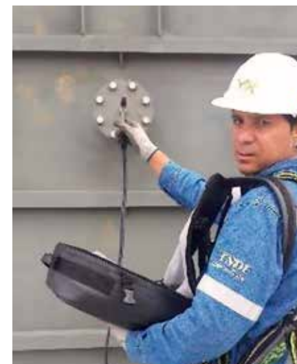
▲ Monitoreo y medición de gases de escape a la Unidad ALT 01 por personal de ENDE VALLE HERMOSO S.A. – Central Termoeléctrica El Alto
