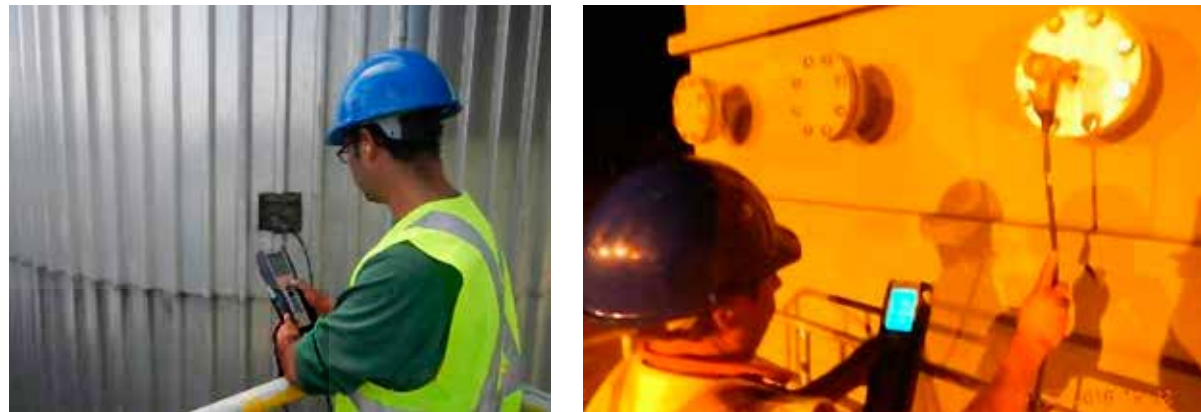
▲ Monitoreo y medición de gases de escape a la Unidad CAR 02 y CAR 03 respectivamente efectuado por Servicio Externo – Central Termoeléctrica Carrasco
