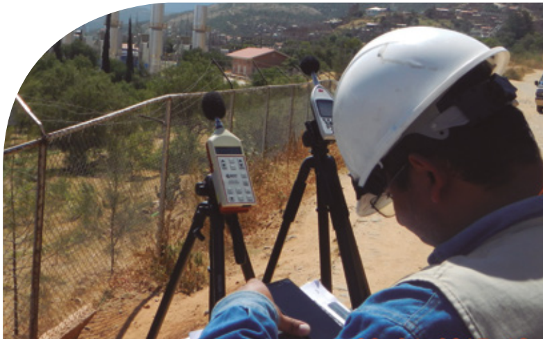
Medición de Niveles Sonoros de Ruido Perimetral – Central Termoeléctrica Valle Hermoso
