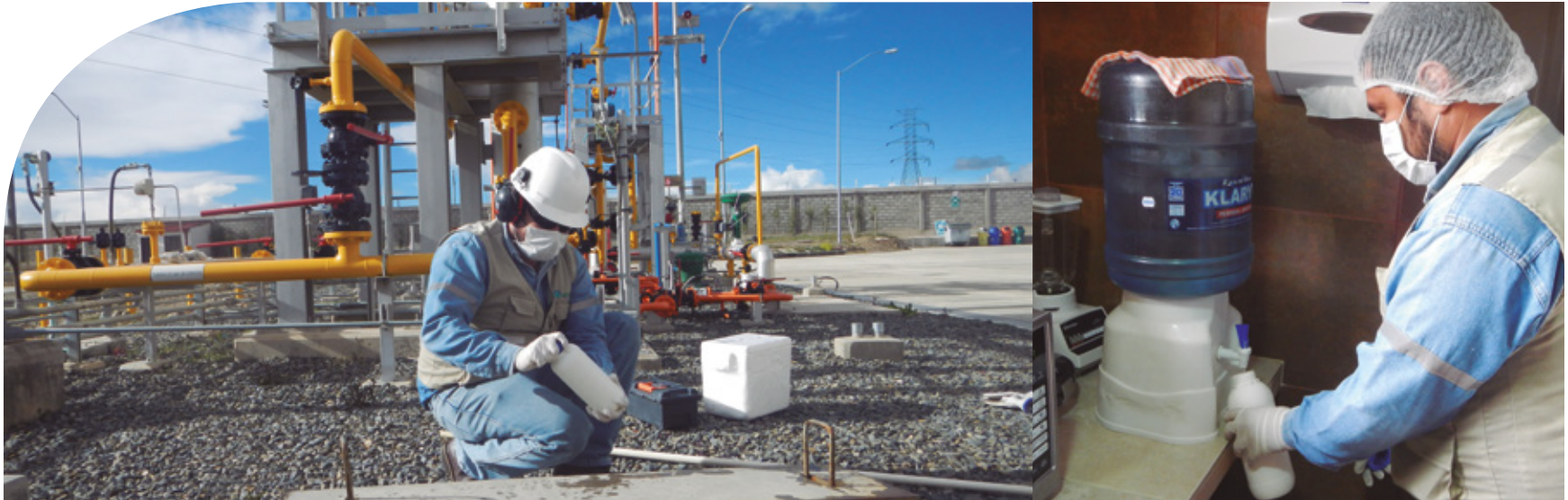
Muestreo de agua de consumo en cafetería, sala de control y muestreo de agua residual en cámaras del área industrial
