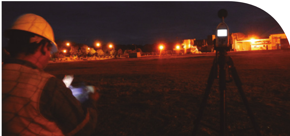
Medición de Niveles Sonoros de Ruido Perimetral Nocturno (Servicio Mo- nitoreo Externo QUEBRACHO) - Central Termoeléctrica Carrasco
