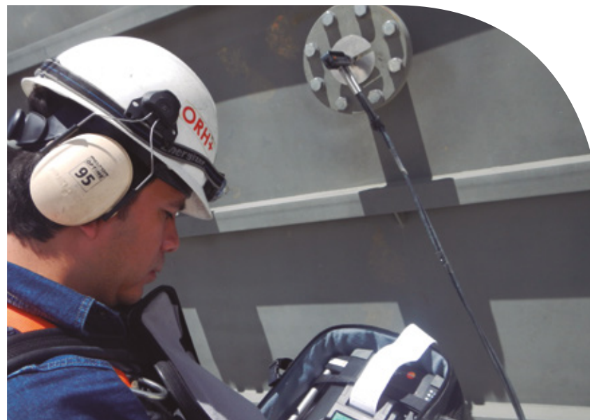
Monitoreo y medición de Gases de Escape a Unidad ALT 02 – Rolls Roys Central Termoeléctrica El Alto
