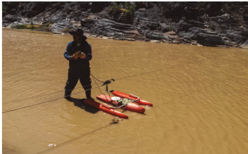
Realización de aforos mediante ADCP
