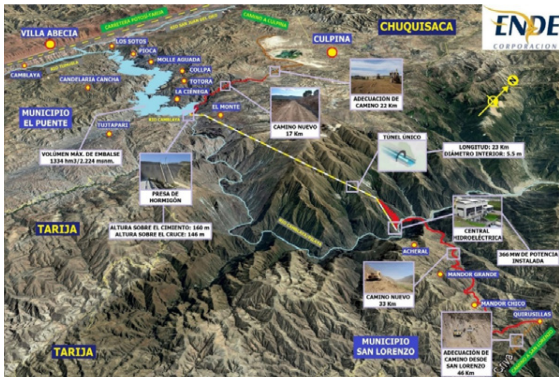
Esquema de obras del Proyecto Hidroeléctrico Ivirizu
