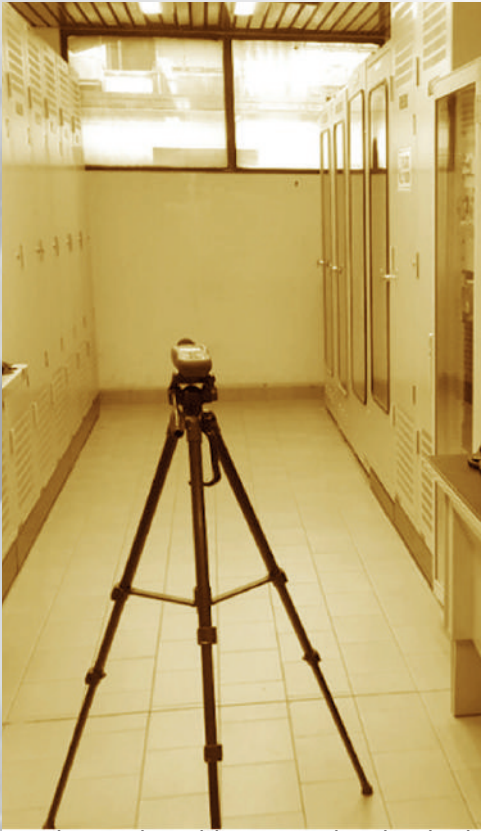
Monitoreo de Ruido Ocupacional Sala de Control Local (Central Termoeléctrica Carrasco)
