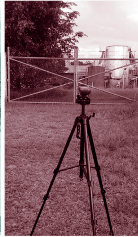
Monitoreo de Ruido Perimetral Diurno y Nocturno (Central Termoeléctrica Carrasco)
