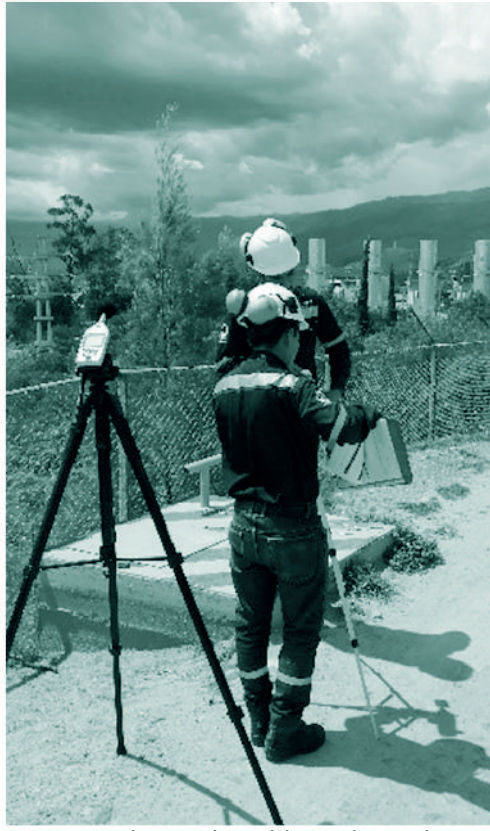
Monitoreo de Ruido Perimetral (Central Termoeléctrica Valle Hermoso)
