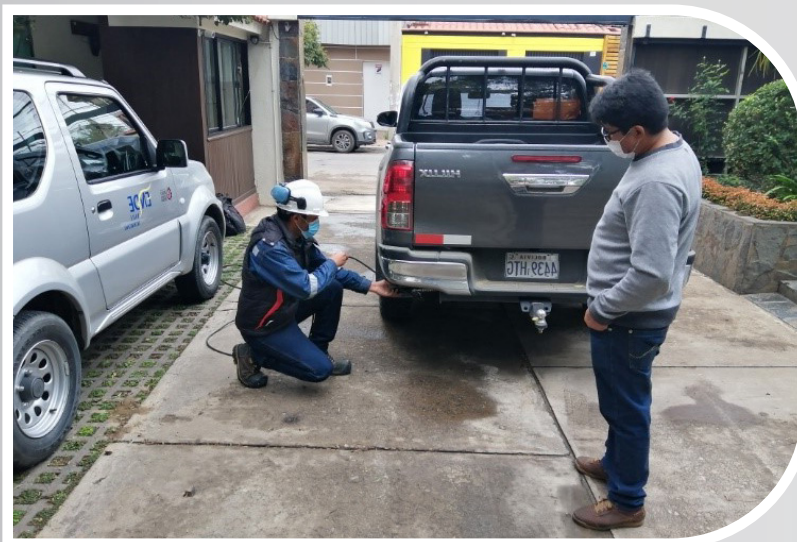
Monitoreo de gases de combustión fuentes móviles parque automotor EVH (oficina central)
