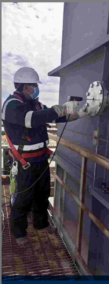
Monitoreo de Gases de Combustión Exteriores Pilas según Régimen de Operación (Central Termoeléctrica El Millo)
