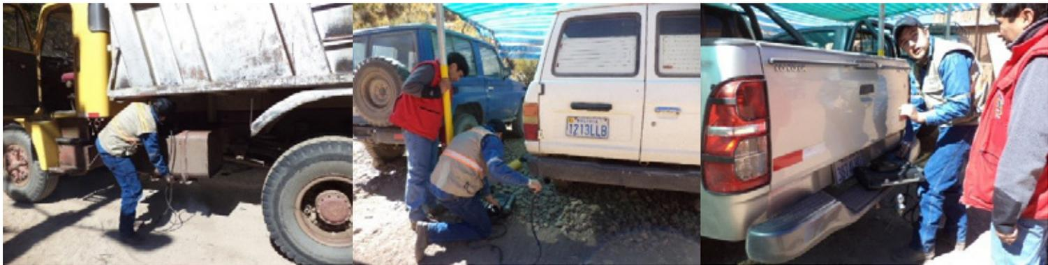
Medición de Gases de Combustión de Vehículos – Parque Automotor Plantas Hidroeléctricas Rio Yura
