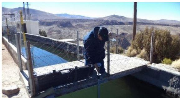
Medición de flujo en canal de Cámara de Carga Kilpani.
