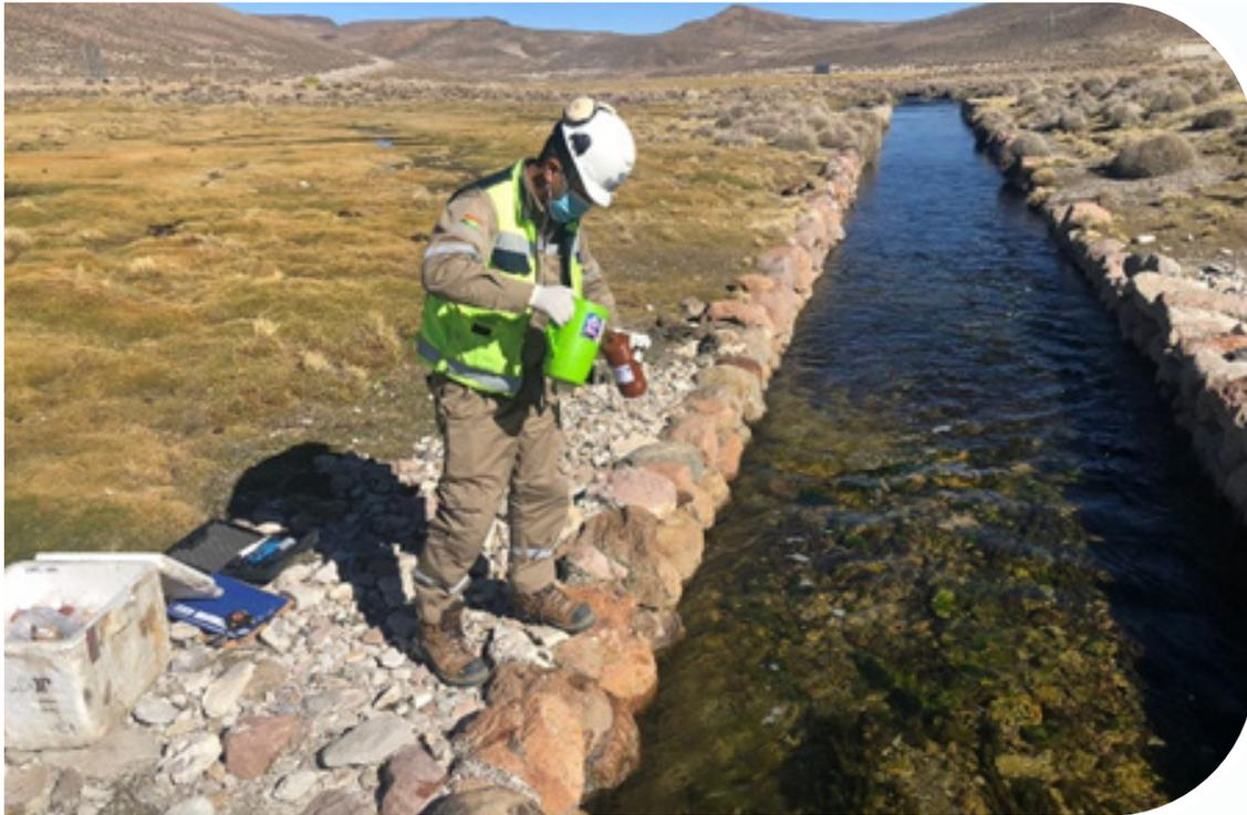
*Muestreo de agua residual en los diferentes embalses a lo largo del circuito de generación hidroeléctrica*
